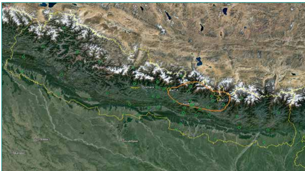
Fig. 2 - Una mappa delle stazioni GPS CORS in Nepal e, in arancione, l'area della frattura provocata dal terremoto Gorkha. I GPS e i sensori sismici all'interno della zona del terremoto hanno permesso di studiare dettagliatamente gli effetti del sisma.
