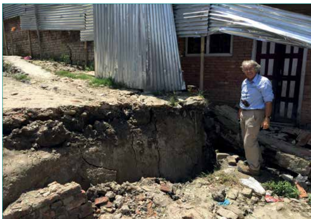
Fig. 4 - Roger Bilham accanto ad una fessura nel terreno di quasi 1 metro prodotta dal terremoto del 25 aprile. Data l'entità del sisma, Bilham si aspettava danni maggiori. (Foto: John Galetzka).
