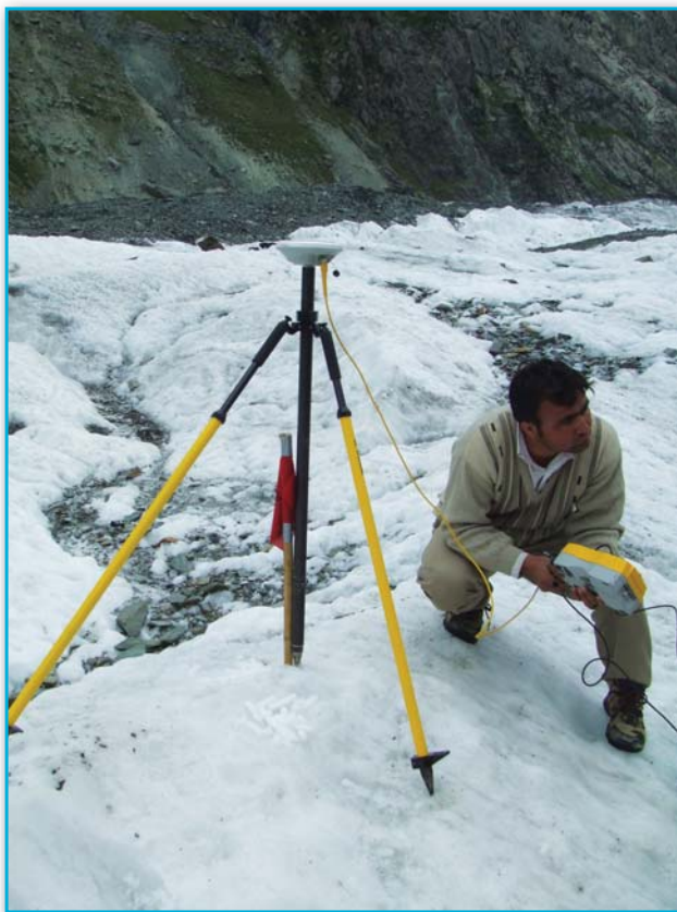
Figura 6 - Misura GPS della posizione di una palina. I dati verranno impiegati per il calcolo della velocità del flusso glaciale.
