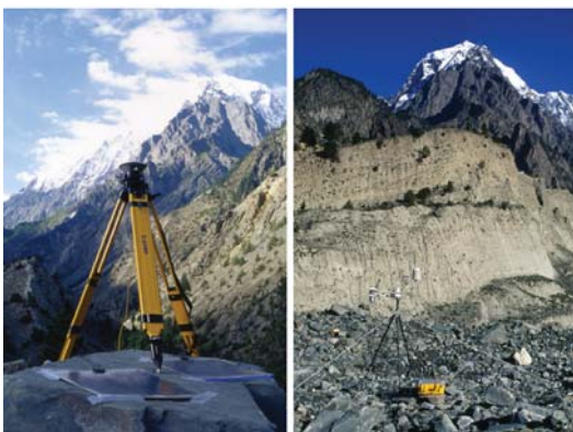
Figura 3 - La stazione master GPS presso la morena (a sinistra) e la stazione meteo automatica installata sul ghiacciaio Hinarche.
