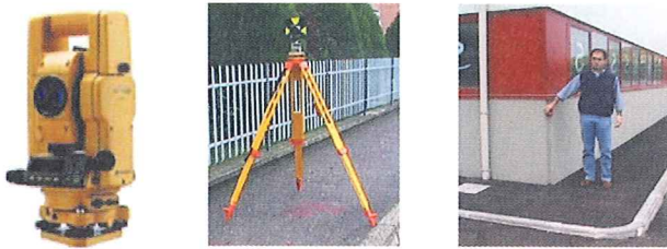
Fig. 2. Teodolite elettronico integrato. Operazioni di rilevamento della poligonale celerimetrica e degli spigoli dei fabbricati.
