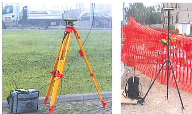
Fig. 5. L'immagine della stazione "Master" e del ricevitore "Rover" durante le operazioni di misura.
