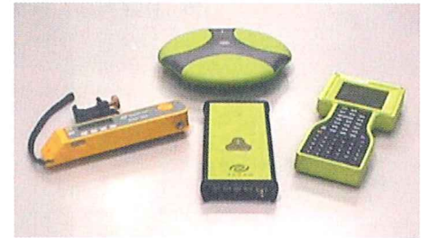
Fig. 4. Il sistema GPS+GLONASS con il distanziometro laser.
