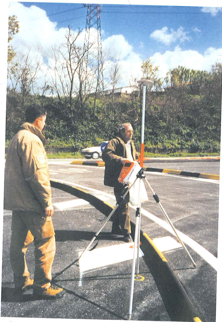
Nella foto il sistema impiegato nel rilievo dei PF e dei punti notevoli, registrando sessioni di circa 15 minuti.
