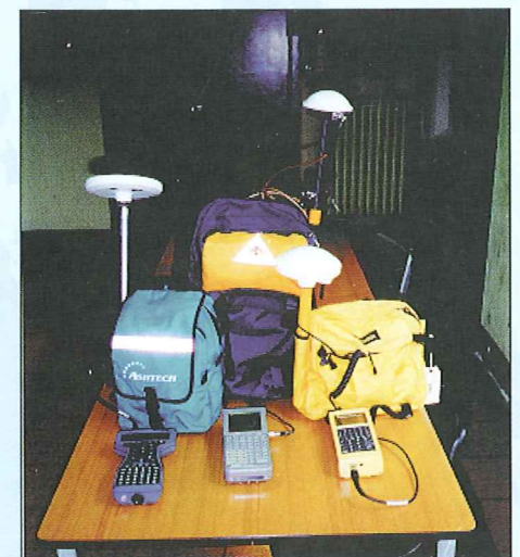
Figura 3 - Alcuni Sistemi GPS/GIS, da sinistra verso destra: il Reliance Ashtech, il Gismo Novatel ed il Pathfinder Trimble (in primo piano i tre Data Logger).
