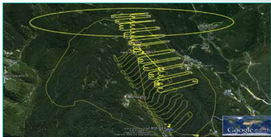
Fig. 1 - Piano di volo per il rilievo UAV di una delle due foreste di test in Val Di Cembra (TN).
