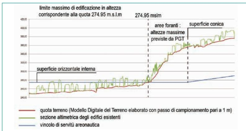
Fig. 5 – Esempio di profilo altimetrico lungo il DDTM, DDSM e la superficie di vincolo.
