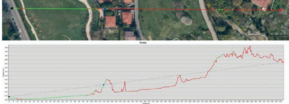
Fig. 2 – Esempio di un profilo altimetrico - linea di vista.
