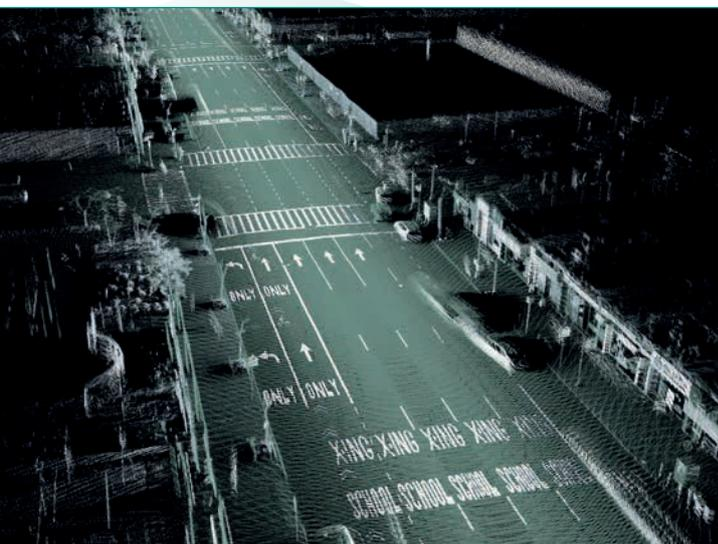
Fig. 6 - Altra ricostruzione di una mappa HD in tre dimensioni da acquisizione LIDAR; anche la segnaletica orizzontale risulta estremamente precisa.
