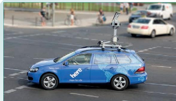
Fig.3 - L'autovettura HERE True munita di strumentazione LIDAR durante l'acquisizione dati.
