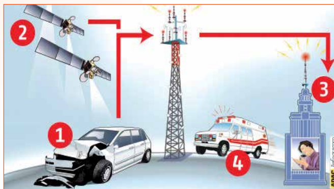
Fig 2 - le quattro fasi d'intervento del sistema eCall. (Fonte: Commissione Europea).
