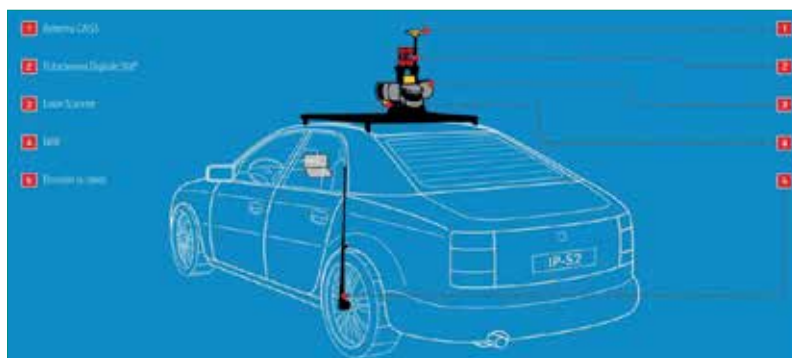
Fig. 8 – Sistema di acquisizione con videocar.
