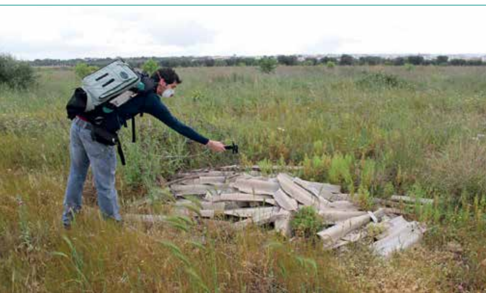
Fig. 7 – Acquisizione della firma spettrale dell'amianto per la verità a terra.
