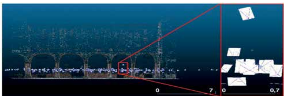
Fig. 1 - Esempio di risultato basato su SfM dove, nonostante un messaggio di processamento completo e un basso errore di riproiezione del bundle adjustment , ci sono delle camere orientate non correttamente.
