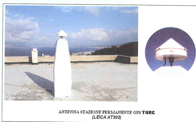
Fig. 2 - Il pilastro su cui è alloggiata l'antenna GPS; sul fondo a sinistra il punto fuori centro CT
