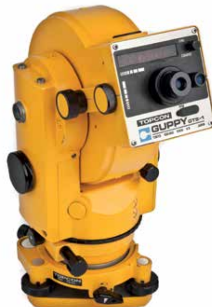
Fig. 1 - La stazione Totale GTS-1, conosciuta anche come "Guppy".
