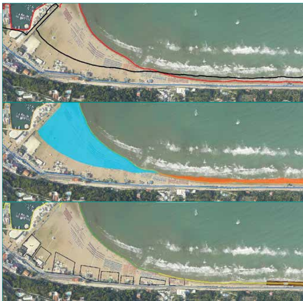
Fig. 2 - Analisi e interpretazione dei fenomeni di erosione costiera. Dal confronto fra le linee di costa rappresentate nel riquadro in alto (al 2005 in nero, al 2017 in rosso) è stata operata una classificazione dei tratti di costa in avanzamento (in celeste nel riquadro al centro), in erosione (in arancione) o stabili (trasparenti, qui non mostrati), che ha rappresentato un criterio chiave per la valutazione dell'ammissibilità della deroga all'insufficiente profondità della spiaggia, non riconosciuta per la concessione vigente rappresentata dal poligono marrone a sinistra nel riquadro in basso. Si osservi la "migrazione" verso la battigia degli ombrelloni nell'ampio tratto in marcato avanzamento a ridosso del molo di sottoflutto.
