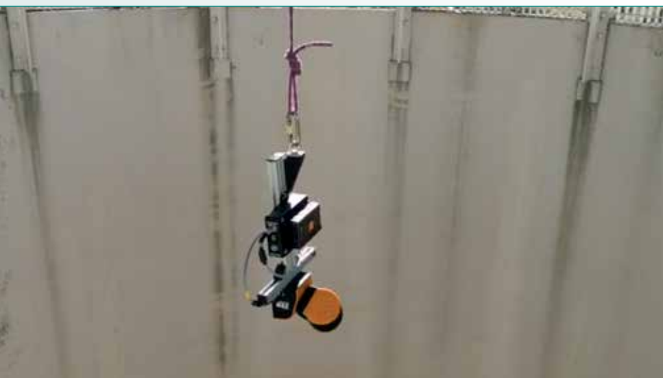
Fig. 1 - Supporto per sospensione utilizzato per calare il Sistema Mobile Mapping ZEB Horizon all'interno del pozzo
