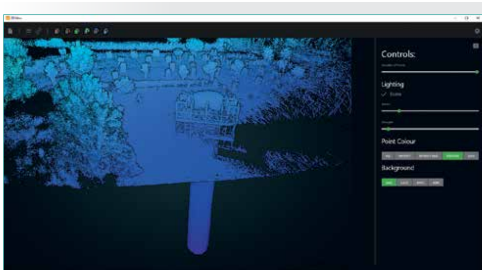
Fig. 5 - Individuazione delle sfere all'interno di GeoSLAM Draw per georeferenziare la nuvola di punti.
