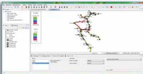
Esempio di utilizzo di JGrassTools come libreria. Il modulo Epanet integrato nel GIS Open Source uDig.
