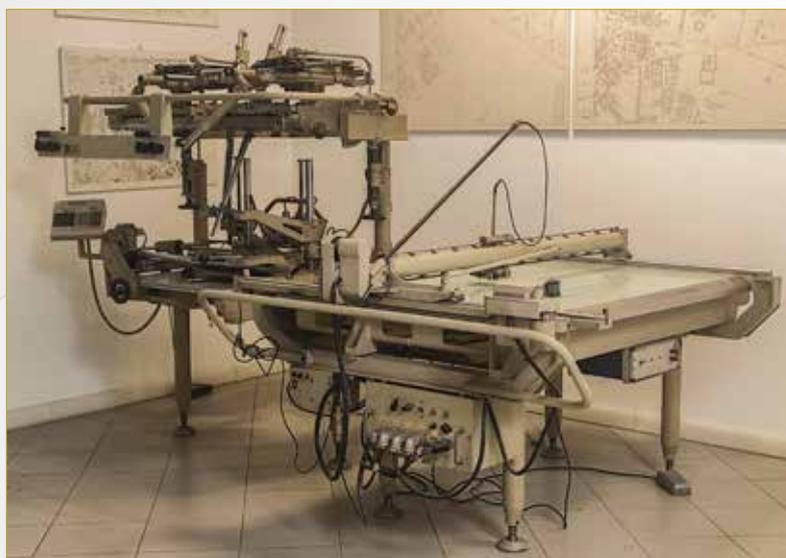
Fig. 1 - Esempio di Stereosimplex Galileo-Santoni IIb prodotto dalle Officine Galileo (Firenze). Questi strumenti permettevano la restituzione in planimetria di ciò che veniva osservato sulle foto aree mantenendo il rigore geometrico;
