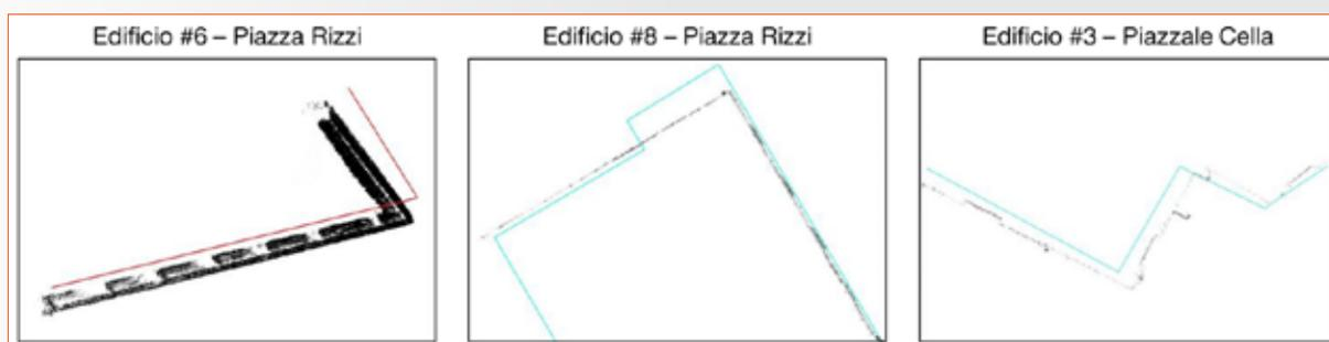
Figura 5: Esempi di confronto visivo tra le geometrie del database geo-topografico (in ciano le unità volumetriche degli edifici, in rosso gli elementi di copertura) e la nuvola di punti ottenuta con laser scanner portatile SLAM. Negli edifici mostrati si possono osservare chiaramente discrepanze tra i due dati ed errori presenti nella cartografia.
