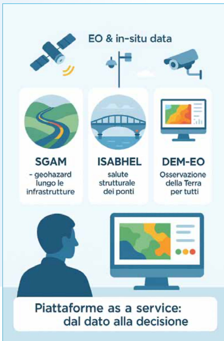
Figura 1: Piattaforme as a service sviluppate da NHAZCA per l’assessment e il monitoraggio di asset esposti a rischi geologici: SGAM™ per le infrastrutture lineari, ISABHEL per i ponti e DEM-EO per la democratizzazione dell’Osservazione della Terra
