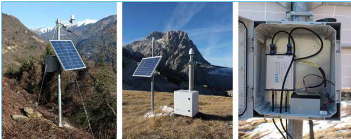
DISPLAYCE: sistema di monitoraggio spostamenti.
