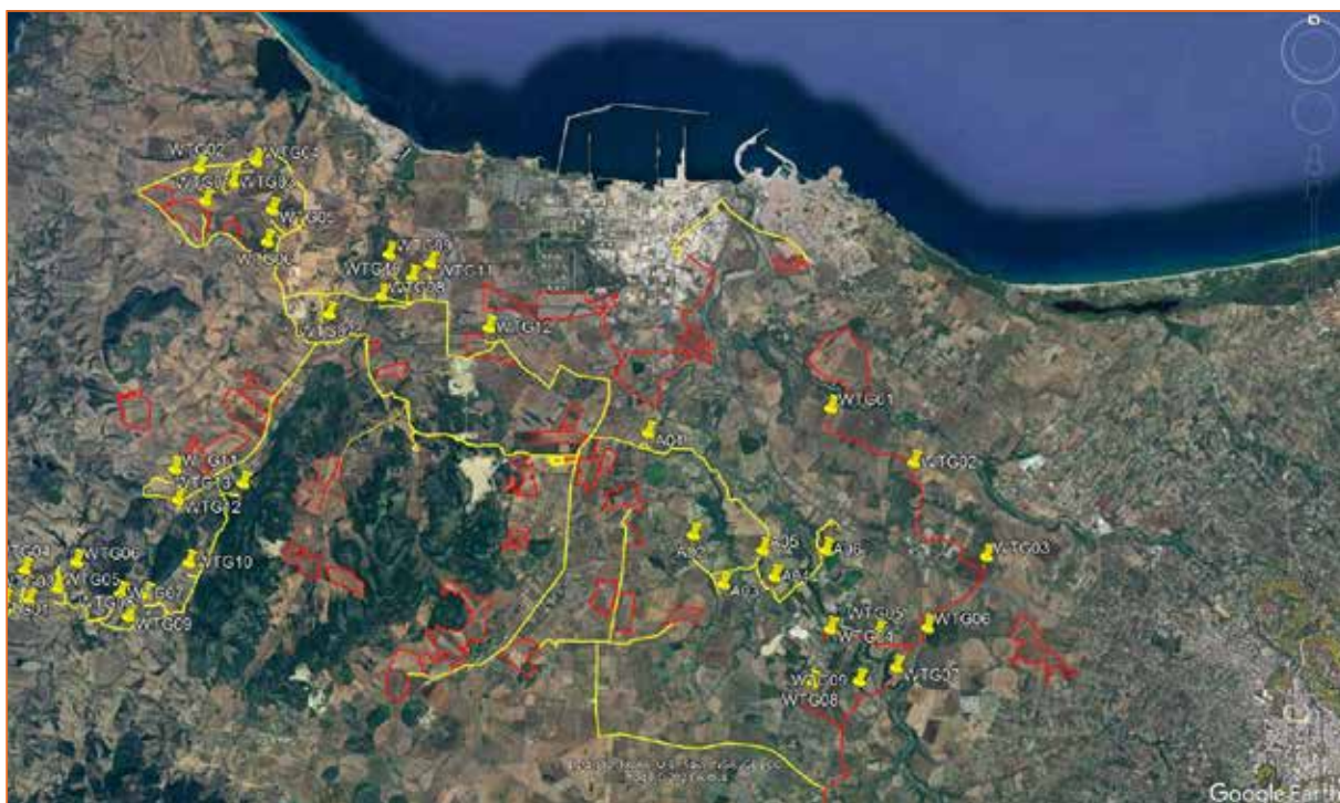
Fig. 2 - impianti foto e agrovoltaici (perimetri rossi), eolici (punti gialli) e relativi cavidotti (linee gialle) tra i centri di Sassari, in basso a destra nella foto, e Porto Torres, in alto- Elaborazione GIS dell'autore su base cartografica Google Earth.
