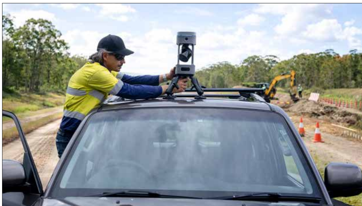
Fig. 4 - Il sistema Emesent GX1 supporta diverse configurazioni operative: installazione su veicolo, utilizzo a zaino o su asta topografica.
