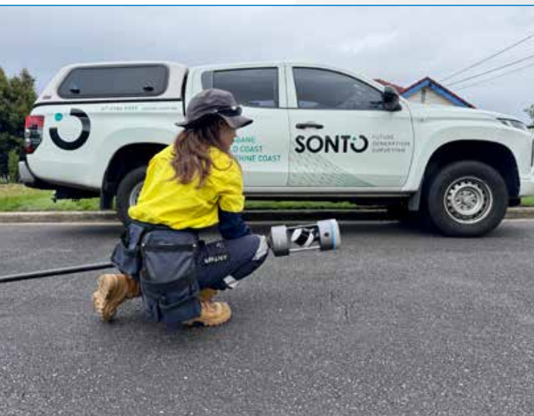
Fig. 1 - Il team Sonto durante le attività di test sul campo con il sistema Emesent GX1, in condizioni operative reali.
