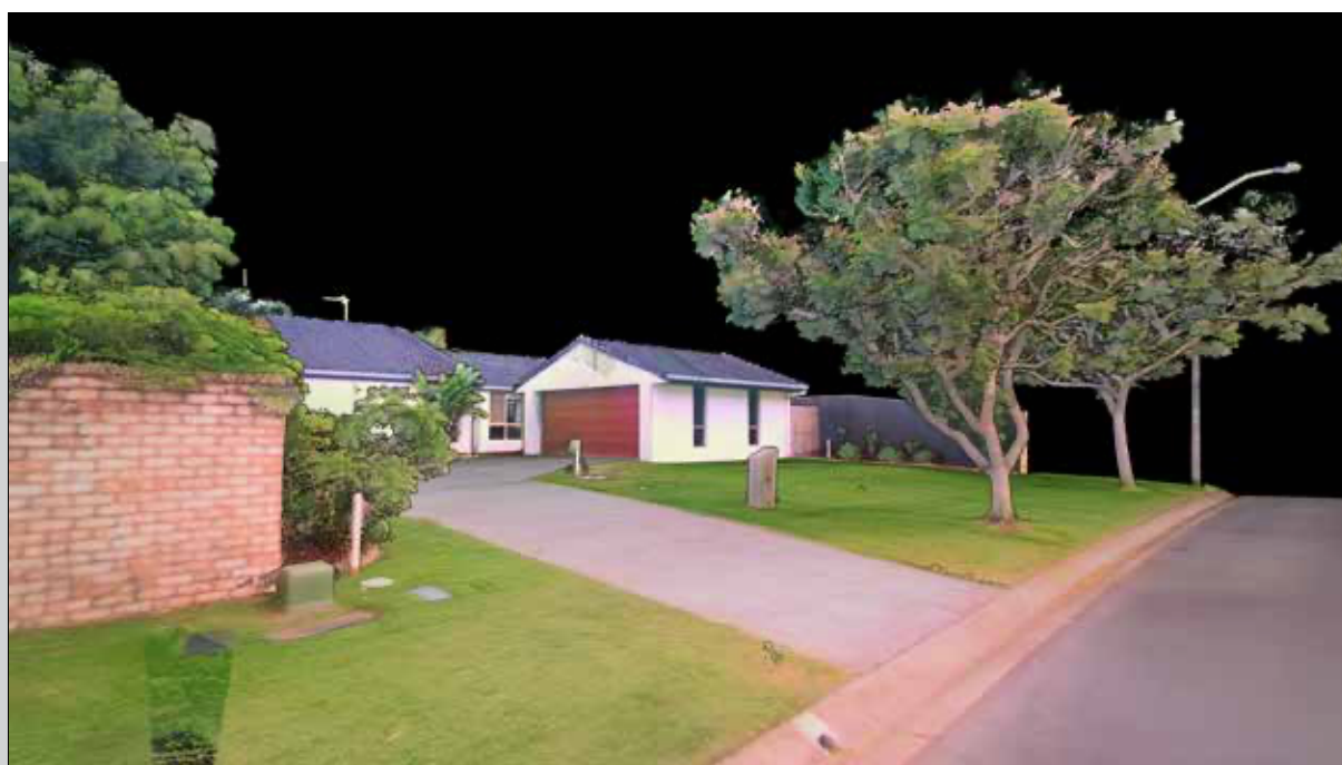
Fig. 2 - Nuvola di punti generata dai sistemi LiDAR SLAM di Emesent, esempio della qualità e densità del dato acquisito.
