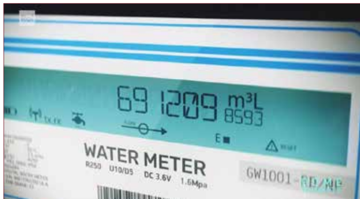
Un contatore idrico intelligente connesso alla rete IoT: in Italia si disperdono oltre 3 terawattora di energia solo per l'acqua immessa in rete e non distribuita. Sistemi di monitoraggio in tempo reale come questo sono al centro della ricerca FP8 per una gestione idrica data-driven. (Fonte: RAI / Fondazione Rome Technopole)
