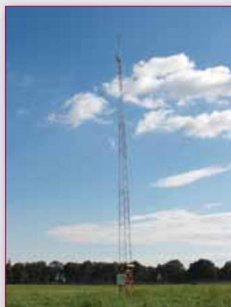
Il radiofaro non direzionale è il capostipite delle radioassistenze e fornisce al pilota un orientamento ottenuto mediante il radiogoniometro di bordo. E' il trasmettitore più semplice che si possa immaginare ed il ricevitore di bordo è altrettanto semplice.
