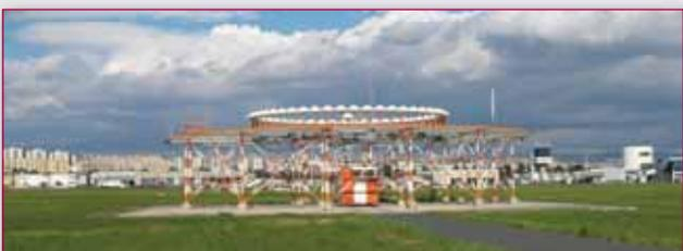
L'apparato VHF Omnidirectional Range, al quale è spesso associato un Distance Measuring Equipment, due sistemi diversi (ed anche indipendenti) che forniscono una indicazione di direzione e distanza con la possibilità di selezionare una radiale precisa. E' ancora uno strumento utile alla radionavigazione di area e di crociera e può essere usato per avvicinamenti non di precisione.
