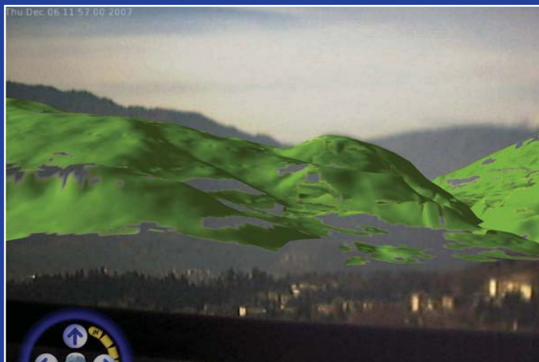
Figura 3: gli strati informativi possono sia essere visualizzati come applicazione 3D tradizionale (destra) ovvero in Realtà Aumentata (sinistra) direttamente sovrapposte alle immagini della scena reale
