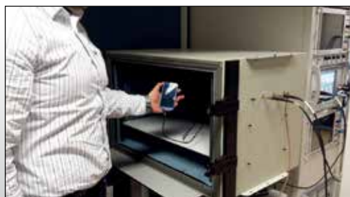
Octobox per i test Galileo dell'ESA, una mini camera anecoica in cui telefoni cellulari o dispositivi mobili possono essere collocati, per fornirgli segnali di rete e satellitare simulati.
