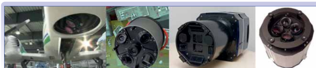
Fig. 2 - Esempi di sistemi multi-camera per l'acquisizione di immagini oblique da aereo.
