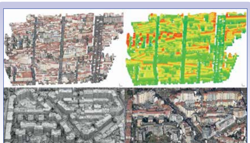
Fig. 6 - Nuvole di punti su un'area urbana visualizzate con informazioni RGB e in modalità color-code (sopra). Dettaglio di un'area in versione ombreggiata e con informazioni colore (sotto).
