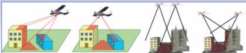
Fig. 3 - Rappresentazione schematica delle diverse occlusioni nel caso di immagini aeree oblique e nadirali.
