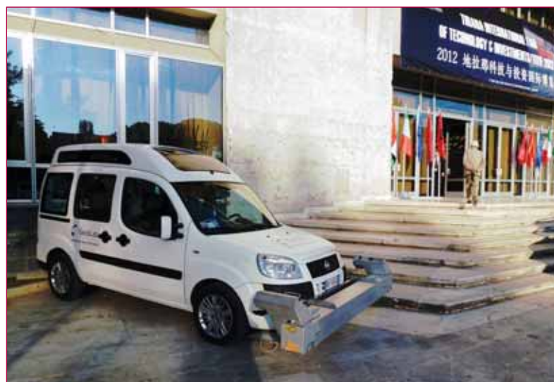
Acquisizione dati in campo grazie al mezzo attrezzato Geoslab che ha acquisito oltre 20 km di strade di Tirana identificandone ampiezza, stato, segnaletica, passi carrai e molto altro.
