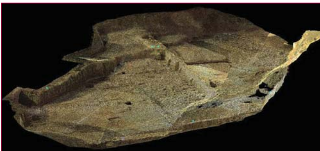
Figura 4 - Nube di punti dell'area scansionata restituita dal Laser Scanner Terrestre.
