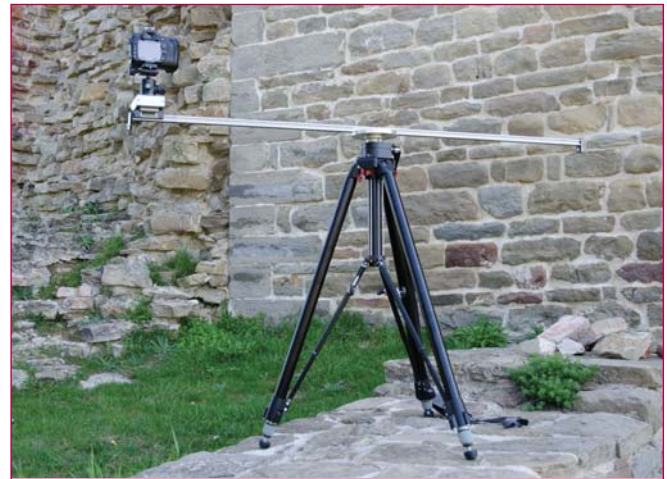
Figure 5, 6 -5) Treppiede fotografico per prese stereofotogrammetriche 6) Dettaglio del treppiede fotografico per prese stereofotogrammetriche: lungo una barra orizzontale di circa 1,4 m (1) può scorrere liberamente un carrello (2-3) che sorregge, tramite una testa a sfera (4), una fotocamera reflex.
