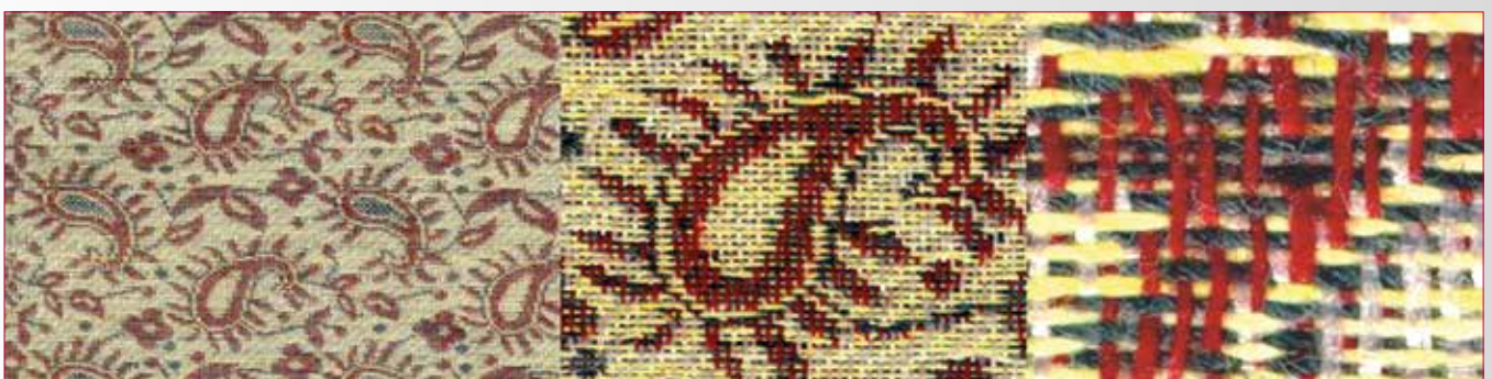
Fig. 7 - Tessuto con disegno ottenuto con intreccio di filati di diverso colore (a sinistra; 7a); particolare del tessuto (al centro; 7b); dettaglio dell'intreccio dei filati (a destra; 7c).
