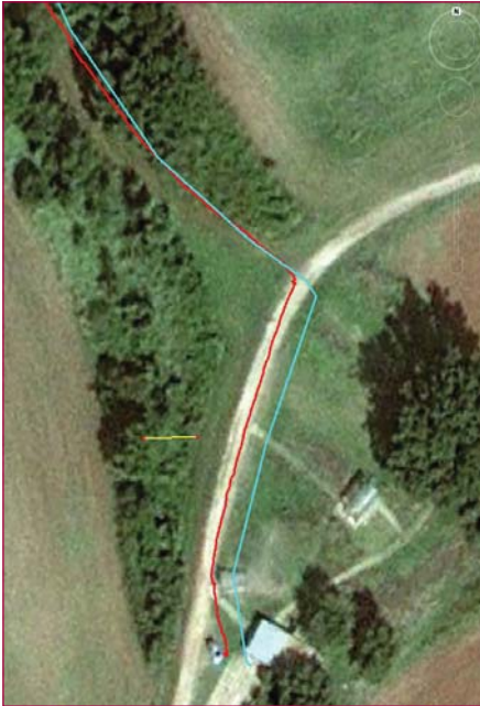
Figura 2 - Primo tratto della T1 misurata (linea blu) e corretta (linea rossa) con uno spostamento medio globale di ca. 4 m verso NW. Il segmento giallo indica una lunghezza di 10 m (sfondo Googleearth®).
