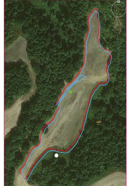
Figura 4 - Zona della traccia T2 chiusa misurata (linea blu) (il tratto con la doppia traccia avanti/dietro presso il pallino verde non si deve considerare poiché il ricevitore era stato acceso in anticipo) e quella corretta (linea rossa). Lo spostamento medio globale è stato di ca. 4 m verso NW. Nel tratto presso il pallino bianco la correzione ha lasciato un errore probabilmente causato dall'orografia (conca) con ostacolo verso sud e quindi con segnale più disturbato. Il segmento giallo indica una lunghezza di 10 m (sfondo Googleearth®).
