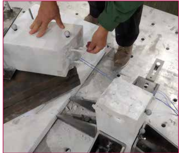
Fig. 5 - Ispezione del provino C2R (ricomposto con sistema RestArt con 3 perni) dopo test di vibrazione a 4.5 g di PGA su tavola vibrante.
