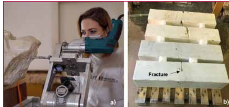
Fig. 2 - Esecuzione di un foro con punta speciale montata sul trapano integrato (a). Provini ricomposti pronti per i test di vibrazione su tavola vibrante (b).
