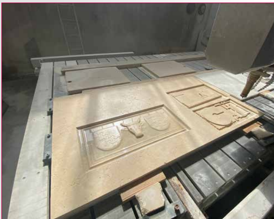
Fig. 2 - Il pannello tattile in corso di fresatura presso il Centro Marmi D'Arcangeli di Priverno.
