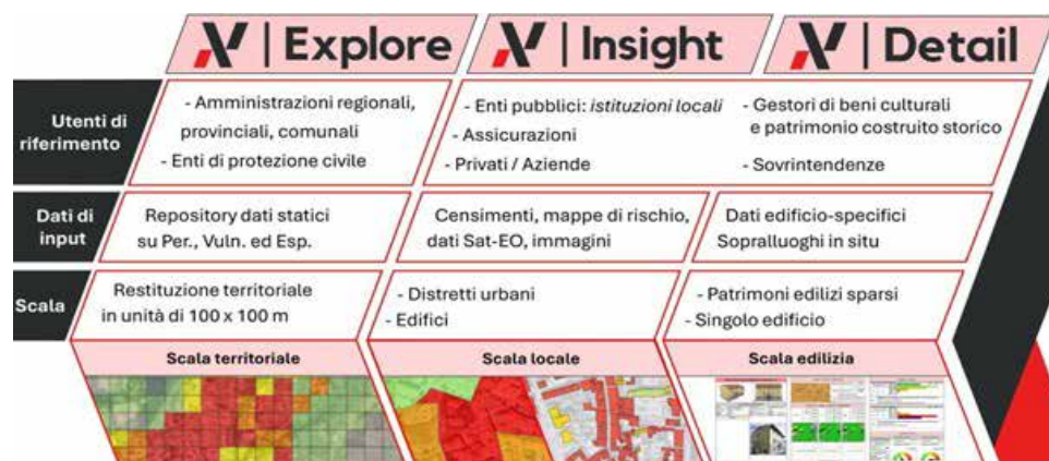
Figura 1 - I tre livelli operativi della piattaforma VALUESAFE - Explore, Insight e Detail - articolati dalla scala territoriale a quella del singolo edificio.
