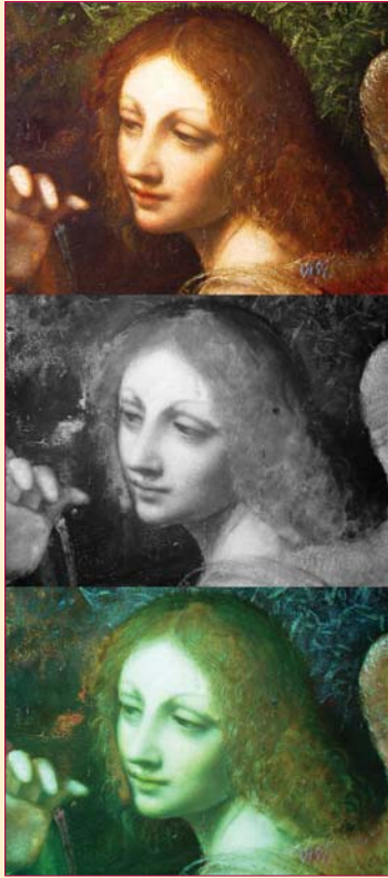
Figura 3 - Bernardino Luini (attr.), Vergine delle rocce, Chiesa parrocchiale, Affori. Immagini del dettaglio dell'angelo in luce visibile, infrarosso e infrarosso falso colore. Le lacune e i reintegri pittorici, visibili in riflettografia come "macchie" dal diverso tono di grigio alle campiture circostanti, si evidenziano nel falso colore grazie alla differente cromia dovuta all'impiego di materiali diversi dagli originali. Analisi eseguite in collaborazione con l'Università degli Studi di Milano, Milano Bicocca e Bergamo.
